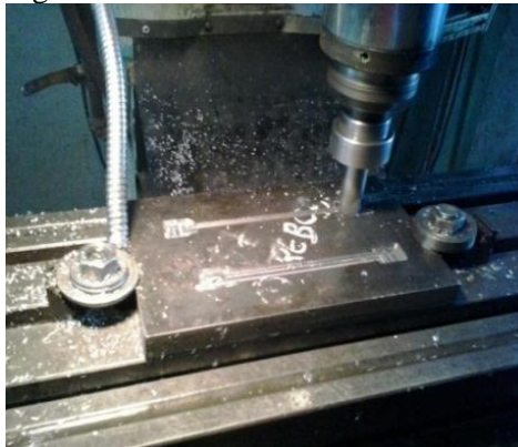
Figura 1. Molde com as duas cavidades.
